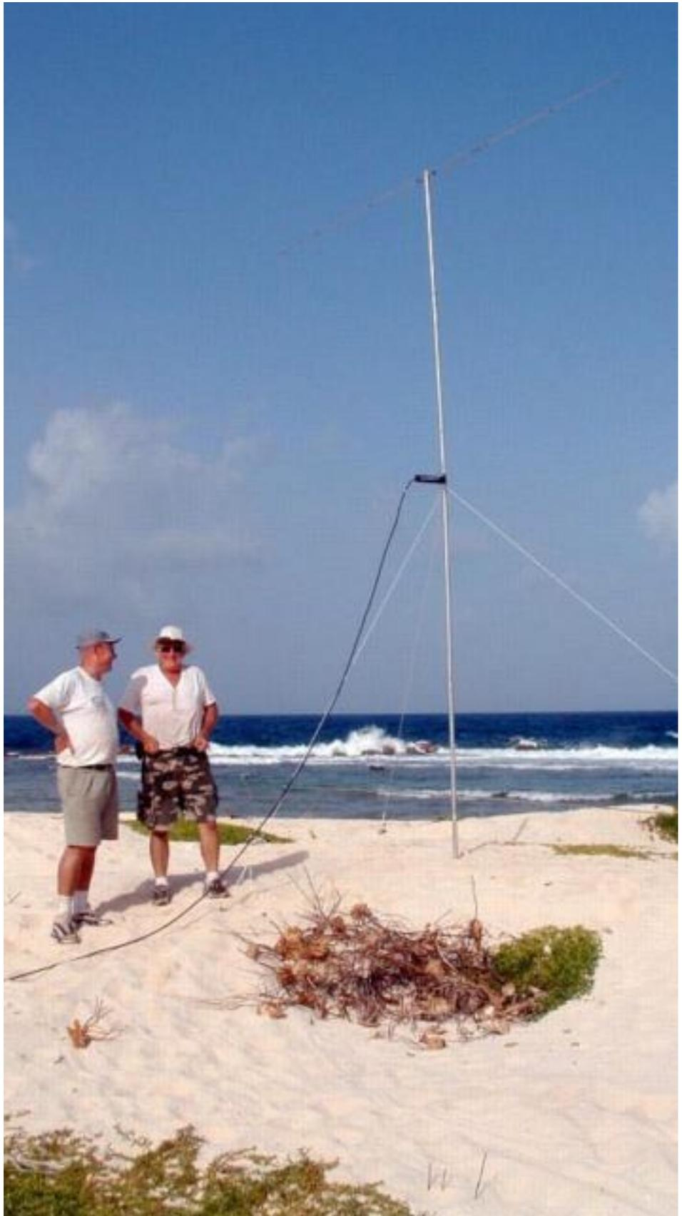
Olli, OH0XX y Mike. K6MYC, finalizando la instalación de la Sigma 20, una de las Antenas FORCE 12 para 20 metros de la Expedición.
