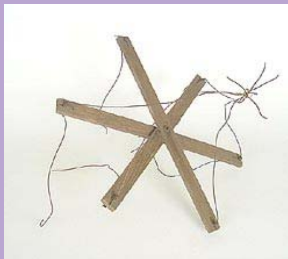
Restos de la antena utilizada en la primera transmisión de una estación de radioaficionados que transmitió a través del Atlántico: Un separador de seis cables de una antena tipo CAGE utilizada por IMO-1XW en 1922 y en 1923 para las primeras pruebas transatlánticas. Esta pieza fue donada a la ARRL por K. B. Warner, W1-EH. Foto ARRL.
