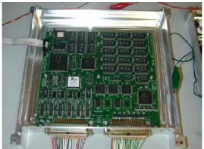
Foto del computador integrado de vuelo desarrollado por Lyle Jonson KK7P
