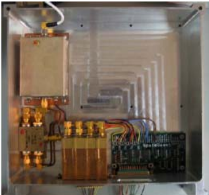
Foto de los 4 receptores de VHF, la tarjeta de interfase, El preamp, los filtros para VHF y un splitter de potencia de 4 vías
