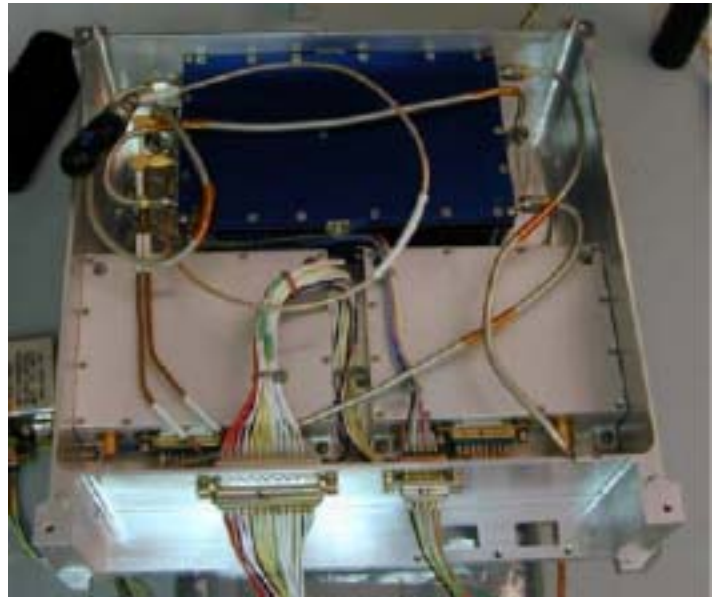
Foto del combinador híbrido de UHF y los dos transmisores
