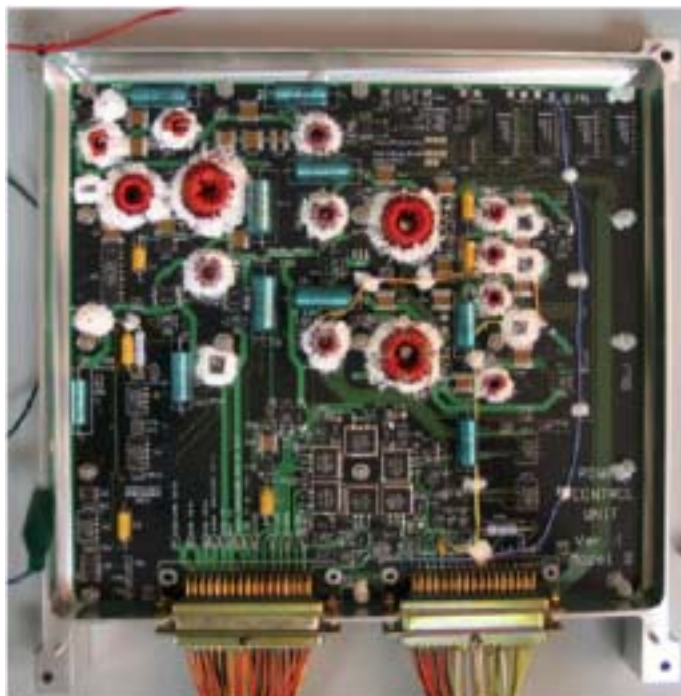
Foto del regulador de control de baterías (BCR)
